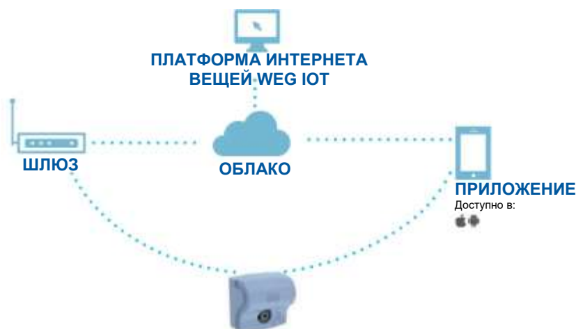
Рисунок 5.2. Процесс обмена данными WEG Motor Scan и анализа
