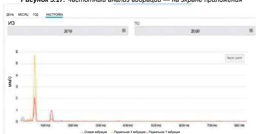
Рисунок 5.18. а: Частотный анализ вибрации — на экране платформы интернета вещей WEG IoT
