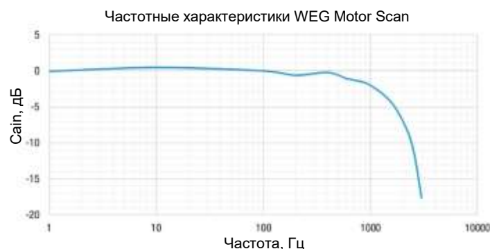
Рисунок 5.5. Соотношение между характеристиками WEG Motor Scan и стандартного калибровочного датчика вибрации, которые одновременно подвергались одинаковой вибрации в широком частотном диапазоне.
