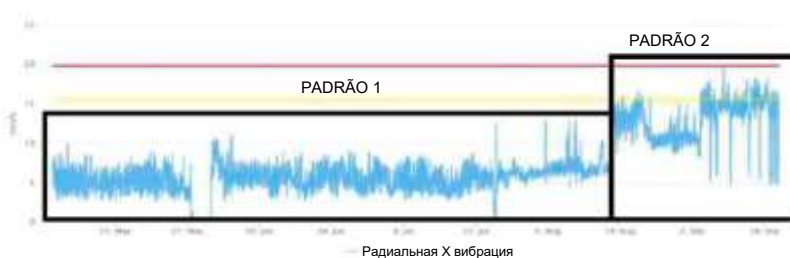
Рисунок 5.23. Пример: Период сбора данных с изменением закономерности в отношении вибрации
