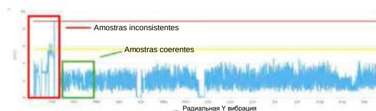
Рисунок 5.22. Пример: Период сбора данных с закономерностями, выявленными в отношении вибрации
