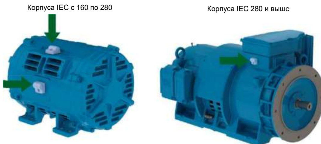
Рисунок 7.5. Место для крепления устройства WEG Motor Scan на электродвигателях W40
